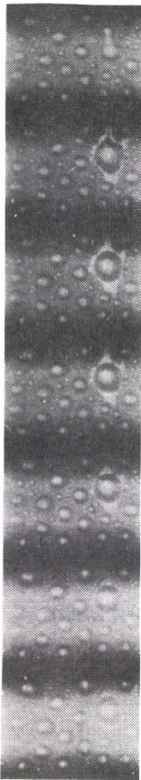
図4 滴状凝縮過程の高速顕微鏡写真 3)
